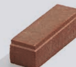
Format Linge® 80/70 Specjalnie formowane, by zapobiec odpryskiwaniu. Ok. 245 x 80 x 70 mm Ok. 50 na m 2
