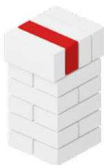
Słupek ceglany 25x25 cm zwieńczenie cegłą pełną ustawioną pionowo
