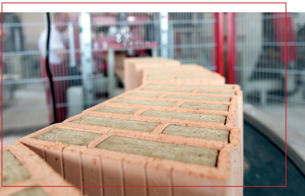
Fot. 14. Produkcja pustaków wypełnionych wełną mineralną
